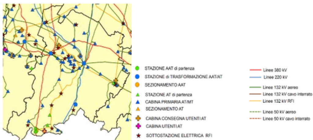
Figura 3.7 Rete di trasporto e distribuzione di energia elettrica ad AAT e AT in Emilia Romagna (elettrodi ed impianti), 2016
